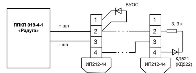
Рисунок 7 – Схема подключения извещателя ИП212-44 к прибору ППКП 019-4-1 «Радуга»
