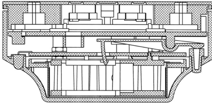
Рисунок 2 – Конструкция извещателя.
