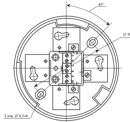
Рисунок 5 – Общий вид розетки с установленным модулем МС-01 (МС-02)
