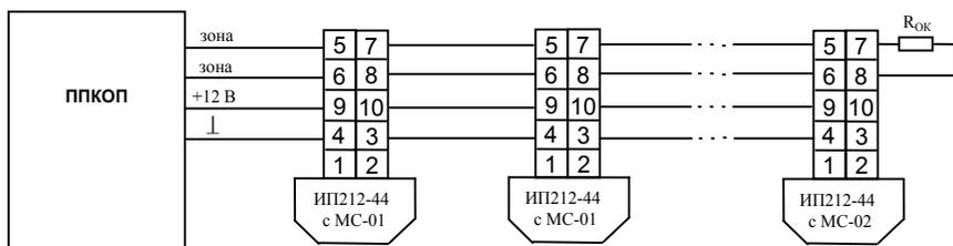
Рисунок 9 – Схема подключения извещателя ИП212-44 к охранно-пожарным приборам
